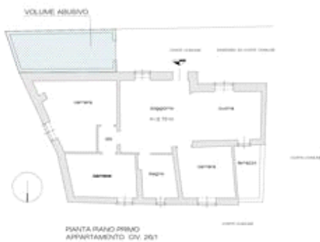
STATO DI FATTO CON INDICAZIONE VOLUMETRIA ABUSIVA SULLA CORTE COMUNE AL PIANO 1
